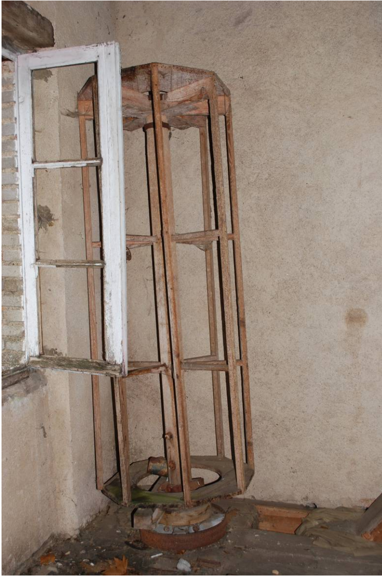
Figure 25 : Premier étage, le mécanisme déposé d'un ancien blutoir.
