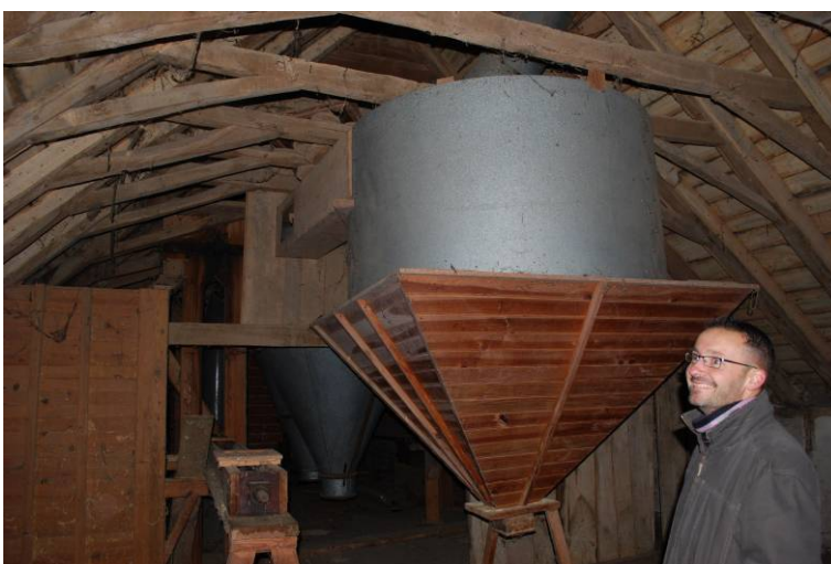
Figure 25 : Deuxième étage : au fond, les silos pour le grain, au premier plan un silo pour l'ensachage de la farine.
